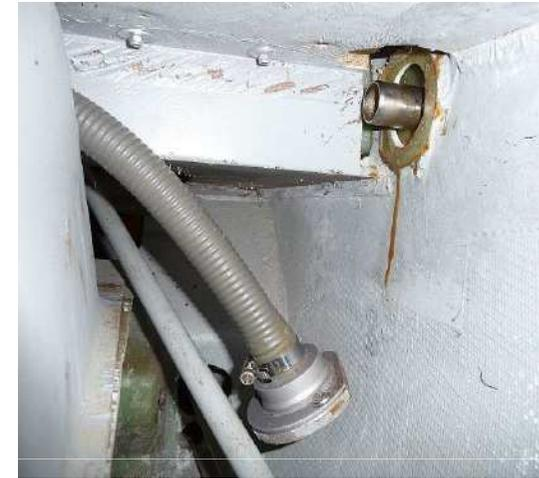
*Exemple de décollage d'un raccord sur un Astir CS*
