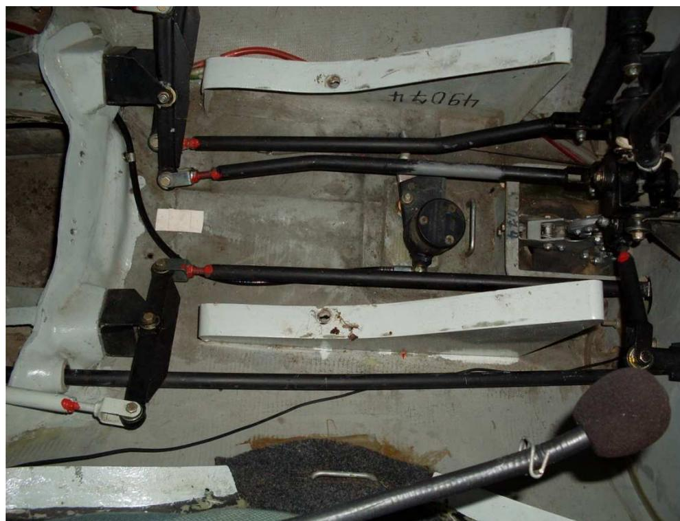
Faites un nettoyage complet du poste, contrôler l'état du baquet et des éléments déposés. Stocker les éléments déposés sur l'étagère dédiée au planeur.
