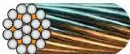
Le câble doit être inspecté en totalité et plus spécifiquement aux endroits où la concentration de contraintes conduit à des détériorations fréquentes (passage en S dans les palonniers). Une usure excessive, un grand nombre de fils brisés, une distorsion des torons, un allongement du pas ou une corrosion importante sont des signes apparents de détérioration
