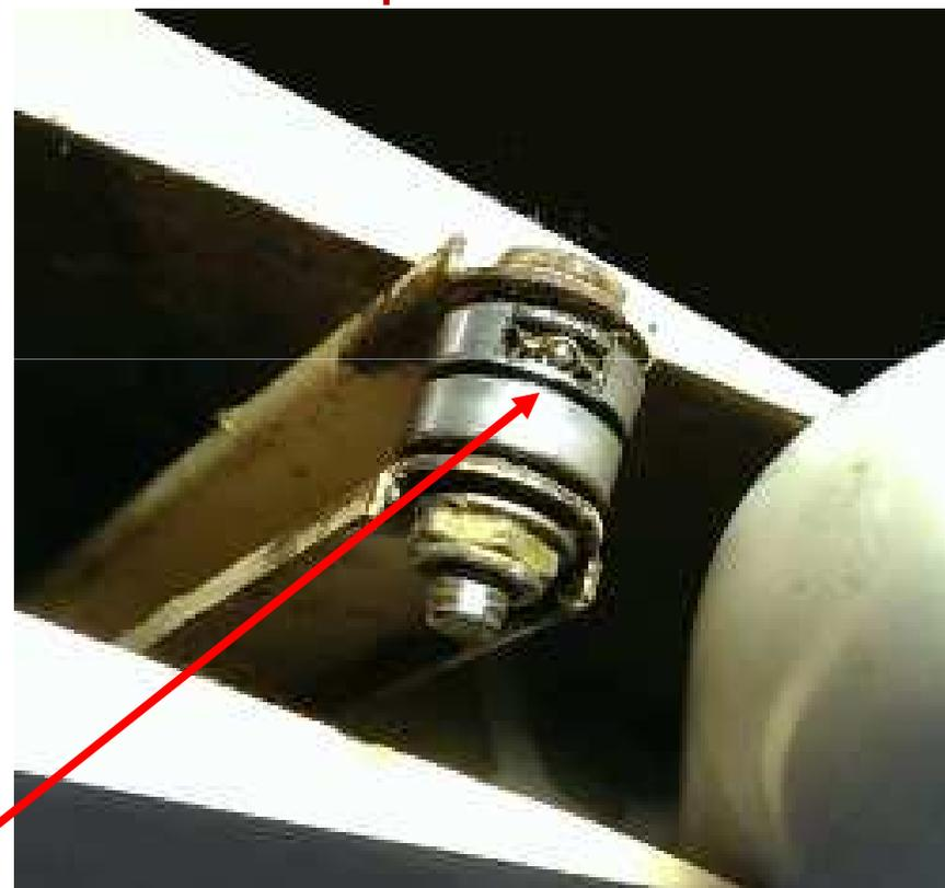
Roulement profondeur C101 endommagé.
