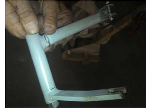
*Le cas ci-dessous représente une rupture en vol de la commande de profondeur d'un Janus B*
