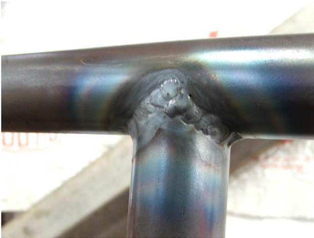
**Il est nécessaire de contrôler les cordons de soudure. En cas de doute appliquer un ressuage.**
