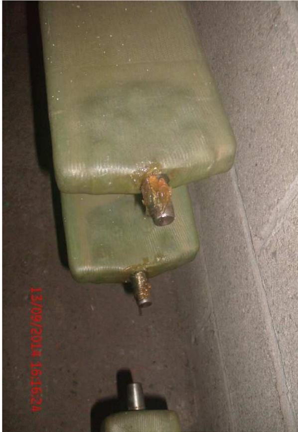
Pensez, aussitôt après le démontage, à dégraisser, le pions de centrage sur les longerons et emplantures côté fuselage et coté ailes (et éventuellement rallonges) ainsi que la profondeur.
